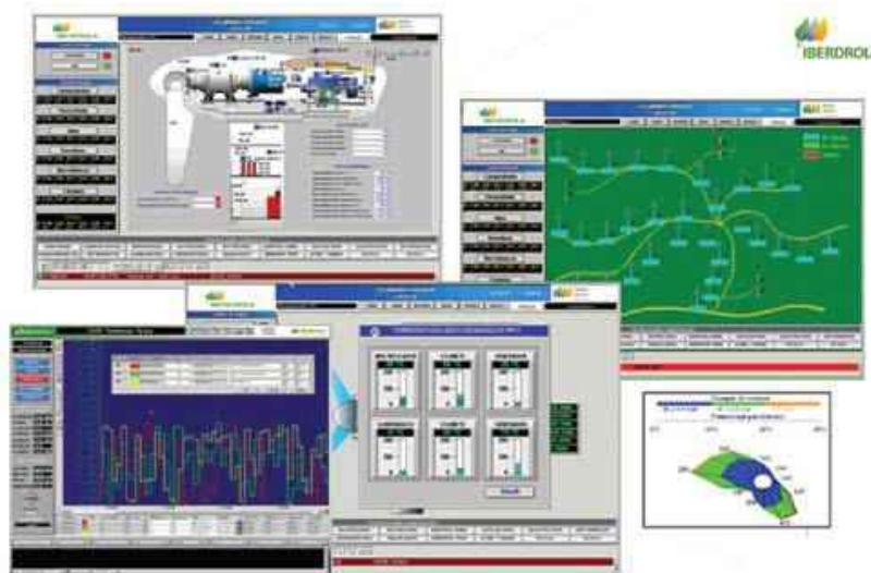
Рис. 2. Примеры мнемосхем PcVue для операторов центра управления CORE
