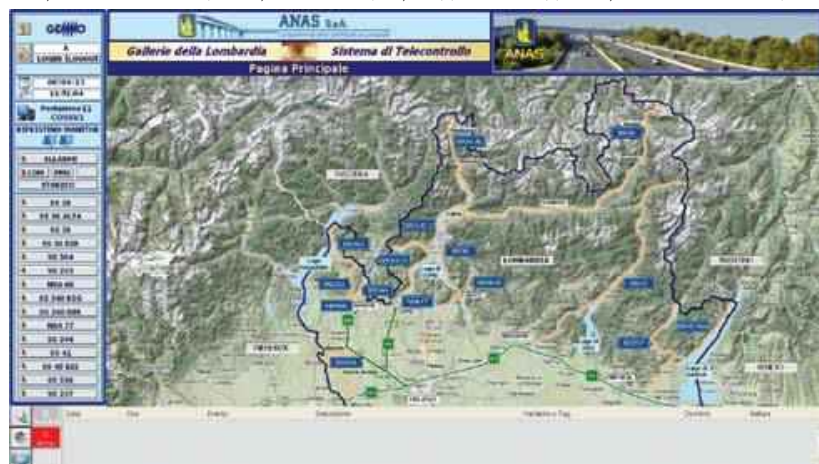
Рис. 7. Система дистанционного мониторинга и контроля туннелей Ломбардии на основе PcVue
