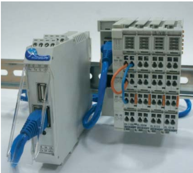
Рис. 2. Внешний вид контроллера Колибри-K1 вместе с модулями ввода-вывода Beckhoff
