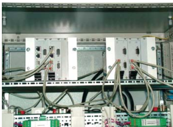
Рис. 2. КТС СИКОН TC1775.K1 на базе микроконтроллера SAK TC1775 (Infineon Technology) RISC-архитектуры, ОС РВ Nucleus Plus и ISaGRAF
