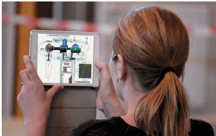
РИС. 2. ◀ Пример контекстно-зависимой мнемосхемы в SparVue, привязанной к близлежащему оборудованию
