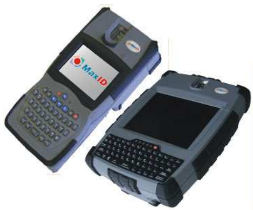
Рис.1 Биометрические устройства iDLMax (слева) и ВНС-100 (справа) компании MaxID на основе процессорного модуля Catalyst от Eurotech Group
