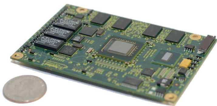
Рис.2 CoM-модуль Catalyst от Eurotech с процессором Atom
