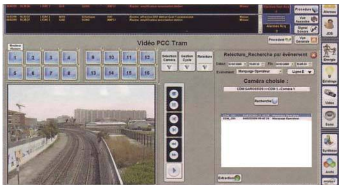
▲ Рис. 2. Пример применения функции “видеомагнитофон” в PcVue в системе диспетчеризации и управления новым трамваем в Тулузе
