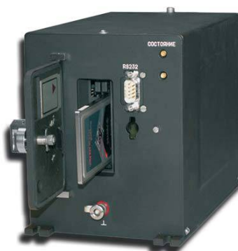
Рис. 6. Защищенный бортовой накопитель ЗБН-МР (ОКБ "Авиаавтоматика") на базе продукции Eurotech Group
