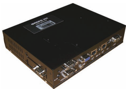
Рис. 6. Коммуникационный ISaGRAF-контроллер ФИОРД-201
