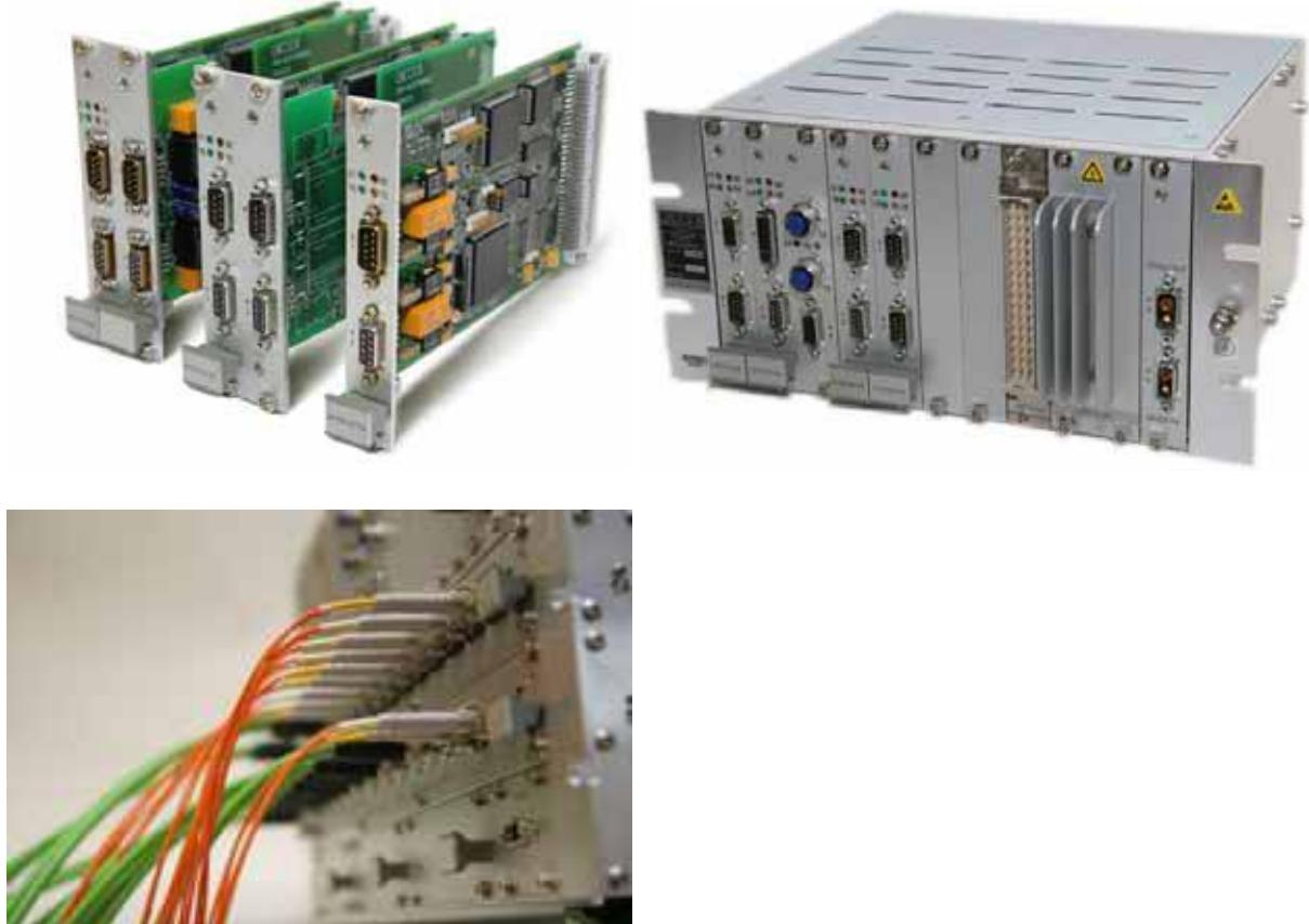
Все оборудование и системы EKE удовлетворяют стандарту EN50155. EKE-Trainnet<sup>□</sup> поддерживает работу с основными протоколами на железнодорожном транспорте WTB/MVB/CAN, а также по Ethernet, RS232/422/485/ WLAN/GPRS/GSM/3G.
