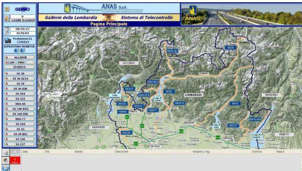
Рис.2 – Система дистанционного мониторинга и контроля, разработанная и внедренная компанией Gemmo SpA и на основе PcVue SCADA от ARC Informatique
