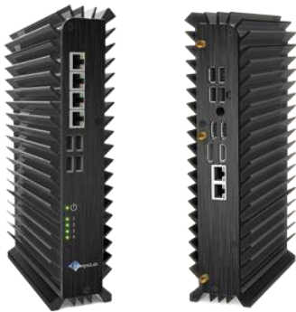
Рис.1 Малогабаритные безвентиляторные сервера uSVR компании CompuLab
